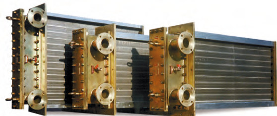
Wärmeübertrager für die Sonderprozeß-Kühlung, z.B. Holzindustrie und Kraftwerkstechnik in der Ausführung mit abklappbaren Sammlerkammern für eine servicefreundliche Innenrohrreinigung
