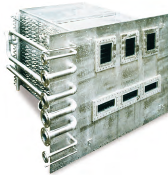
Wärmeübertrager für die Luft-/Dampf-Kondensation bei aggressiven Medien als Direktverdampfer komplett aus dem Material V 4 A mit mehreren Kältekreisläufen für die Kaskaden R 23 / R 404A und integriertem Glycol-Wasser-Kreislauf für den Abtauvorgang des Wärmeübertragers. Für die Anwendung von z.B. Benzin- dampfrückgewinnung, Dichlortoluolkondensation.
